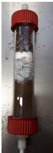
Absorber stark verbraucht.
